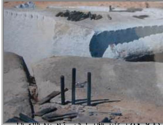
( شكل ١٦ ) استخدام الأزاميل اليدوية لإحداث الفلق الطبيعي للكتل لاستخدامه كملمس أساسي على سطح الجدارية حسب المواصفات المطلوبة لتنفيذ التصميم .
