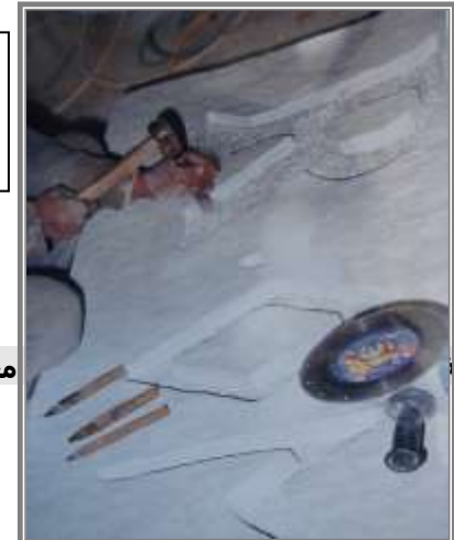
(شكل ٢٦) استخدام الأزميل المسمار في إحداث ملمس ولون مميز، حيث تظهر بعض البلورات المعدنية بلونها الحقيقي نتيجة انشقاق البلورات أثناء عملية النحت
