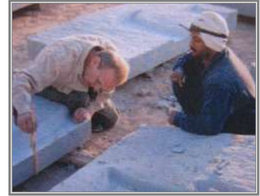
(شكل ٢١) مراحل نحت الكتل وتحديد الحد الأدنى لسمك الكتل وهو ١ سم
