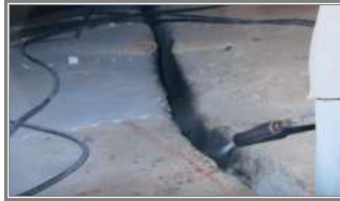
( شكل ١٤ A ) استخراج الكتل الجرانيتية الكبيرة الحجم من المحجر بواسطة مسدس اللهب
