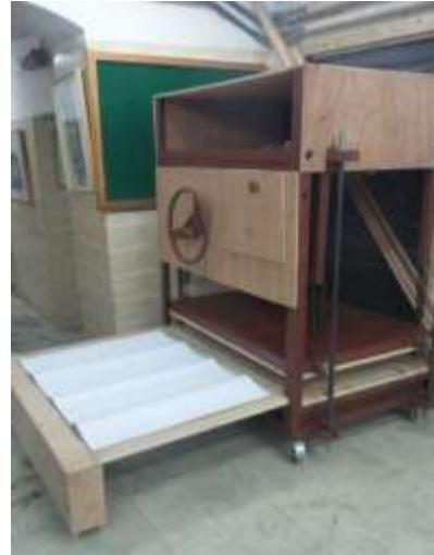
شكل رقم ٢٠: آلة الطباعة ذات الرافعة الميكانيكية ذات المساحة الكبيرة من إبتكار الباحث منفذة برافعة ميكانيكية ترفع بقدرة وزن رأسى ١٠ طن وأبعادها ٨٥ سم عرض × ١١٥ سم طول × ١٦٥ سم ارتفاع : المصدر ( الباحث )
