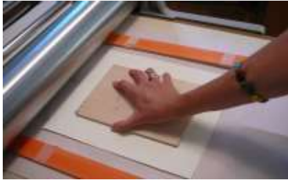
شكل رقم ١١: طباعة بارزة بمكابس أفقية ومحاولة تعويض الفراغات حول القالب الطباعي :
