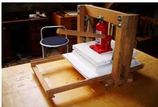
شكل رقم ١٩: آلات الطباعة الرأسية البارزة المبتكرة بواسطة روافع زيوت الهيدرولك والمصنعة بالهياكل المعدنية والخشبية : المصدر ( https://www.tempostaffing.com/block-printing-press/best-press-ideas-images-on-pinterest )
