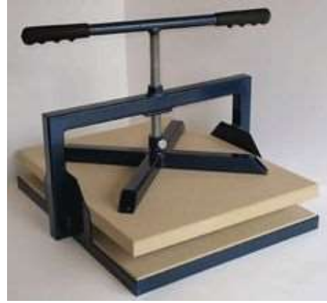
شكل رقم ٥ : بعض آلات الطباعة البارزة الرأسية الحديثة ذات القرص الحلزوني : المصدر ( https://www.mes.net.au/category/696-relief-presses )
