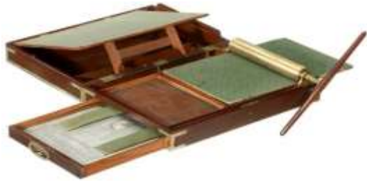
شكل رقم ١٠: آلات النسخ المحمولة بطريقة النقل الرطب Portable The desk top Wet transfer Copies
