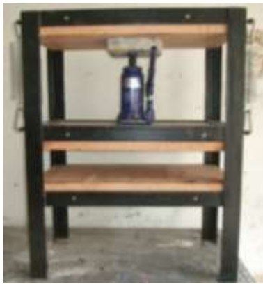
شكل رقم ٢٣: آلة الطباعة ذات الرافعة الهيدروليكية ٤٠سم عرض × ٦٠سم طول × ٨٥سم ارتفاع المصدر ( الباحث )
