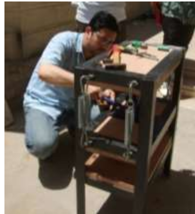
شكل رقم ٢٣: آلة الطباعة ذات الرافعة الهيدروليكية ٤٠سم عرض × ٦٠سم طول × ٨٥سم ارتفاع المصدر ( الباحث )
