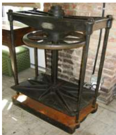
شكل رقم ٤ : آلات الطباعة البارزة الرأسية ذات القرص الحلزوني ذات الأحجام الكبيرة Large Book Binding screw mechanism press المصدر ( https://sturgisantiques.com )
