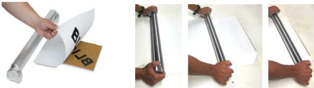
شكل رقم: ١٢ إسطوانات الضغط المحمولة والدوارة للطباعة البارزة : المصدر ( nzprintmakers.com )
