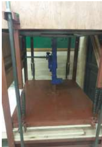
شكل رقم ٢٠: آلة الطباعة ذات الرافعة الميكانيكية ذات المساحة الكبيرة من إبتكار الباحث منفذة برافعة ميكانيكية ترفع بقدرة وزن رأسى ١٠ طن وأبعادها ٨٥ سم عرض × ١١٥ سم طول × ١٦٥ سم ارتفاع : المصدر ( الباحث )
